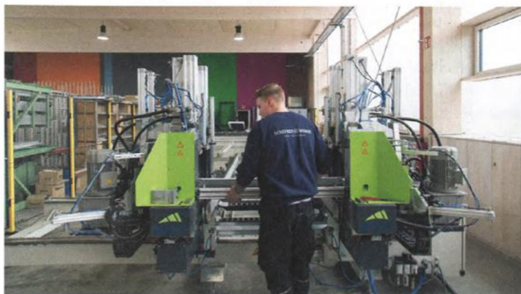
Eine neue Schweißtechnik versetzt das Unternehmen in die Lage, auch Elemente mit besonders feiner Gehrungsfuge zu produzieren.
